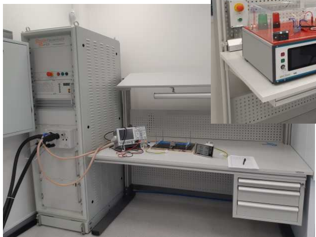
Испытания на нагрев и кратковременными токами
