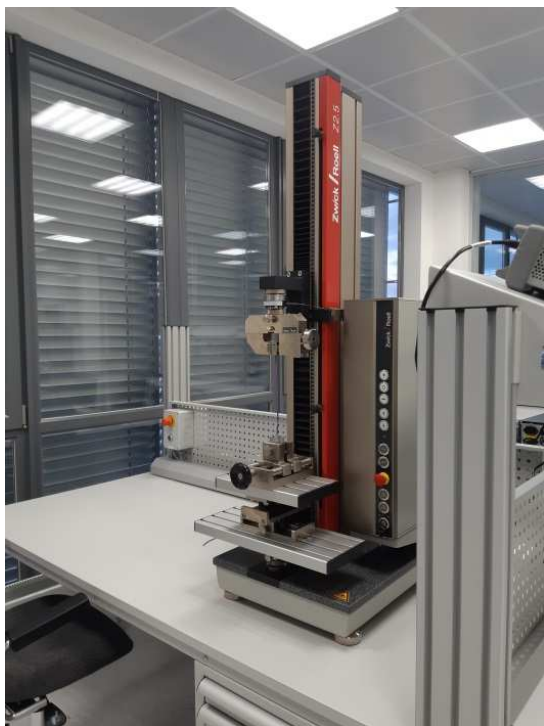
Испытание на извлечение проводника из клемм
