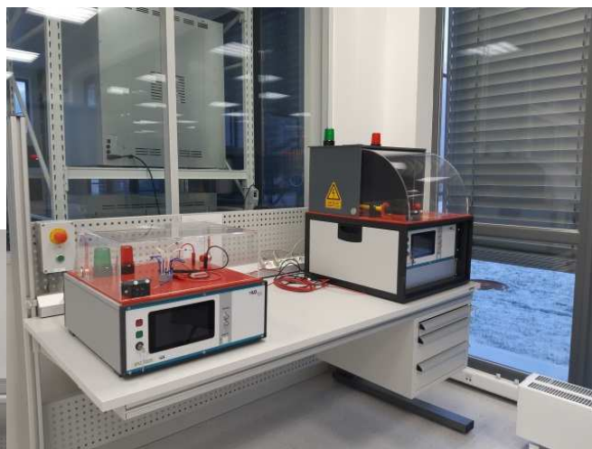
Испытания изоляции и импульсными перенапряжениями
